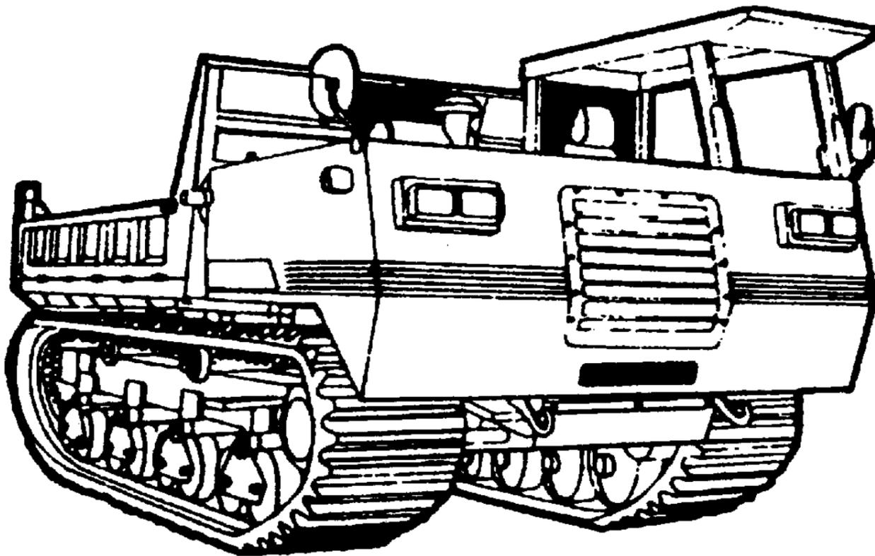
\* 不整地運搬車は、不整地・傾斜地・軟弱地・狭い場所での土砂や資材の運搬作業車として幅広く使用されている運搬車です。
