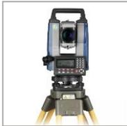
← トータルステーション(高速高精度 計測機器)一式
