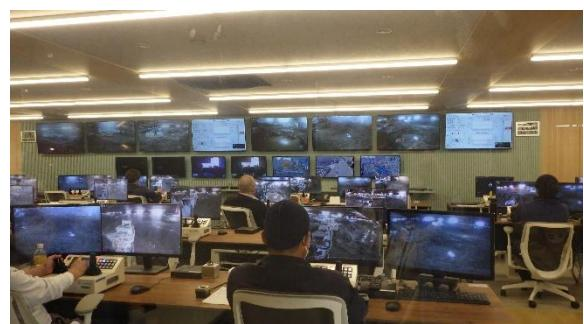
※ 遠隔操作室…地下での掘削を行うケーソン(函)下に付いているショベルをリモートで操縦する
