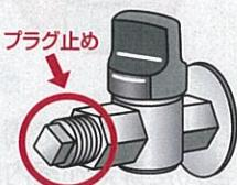
未使用のガス栓は閉栓処理がされていないと、接触等による誤解放によってガス漏れ事故につながります。未使用のガス栓はガス販売店へ連絡し、正しく処理してください。
