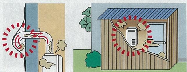
外壁の塗装時に養生シートで給排気設備をふさいだり、屋外式の燃焼器を波板等で囲むと、燃焼器から発生したCOが室内に滞留し、CO中毒の原因になります。
